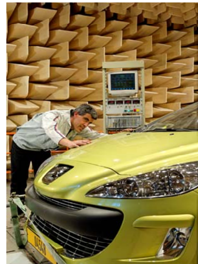
Opérateur préparant un essai de comportement acoustique et vibratoire de Peugeot 308 dans une chambre an..choïque au centre technique de V..lizi
